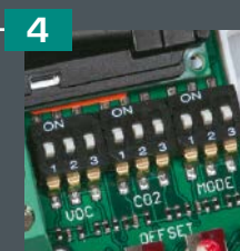
DIP-переключатели Для настройки диапазонов измерения, выходного сигнала, автоматической коррекции нуля и назначения реле для определенной величины
