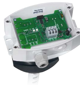
KLGF-U con uscita 0-10V, UB = 24V
