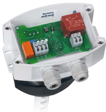
KLSW-W230 con contatto in scambio, UB = 230V
