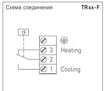
**THERMASREG® TR xx - F** Терморегулятор с дистанционным датчиком, одноступенчатый
