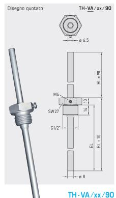
Pozzetto a immersione in acciaio inox V4A (1.4571) con collo di estensione
