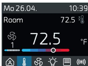
Interfaccia per la gestione di temperatura, ventilazione, luce e protezione dal sole
