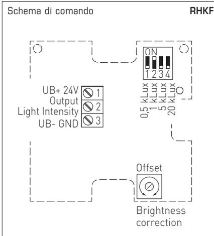
**PHOTASGARD® RHKF** Sonde di luminosità per ambiente
