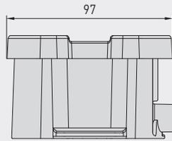
Involucro con **avvitamento cavo** a livello standard con collegamento **rapido** a innesto per flessibili in pressione
