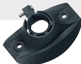
Capteur de débit d'air pour montage en gaine, resp. convertisseur de mesure pour vitesse d'écoulement, débit volumique et température, avec bride de montage, étalonnable, avec raccordement Modbus
