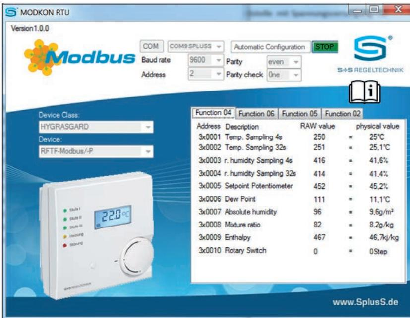
На рисунке показано окно ПО S+S MODKON RTU (входит в комплект поставки) на примере датчика S+S HYGRASGARD® RFTF-Modbus
