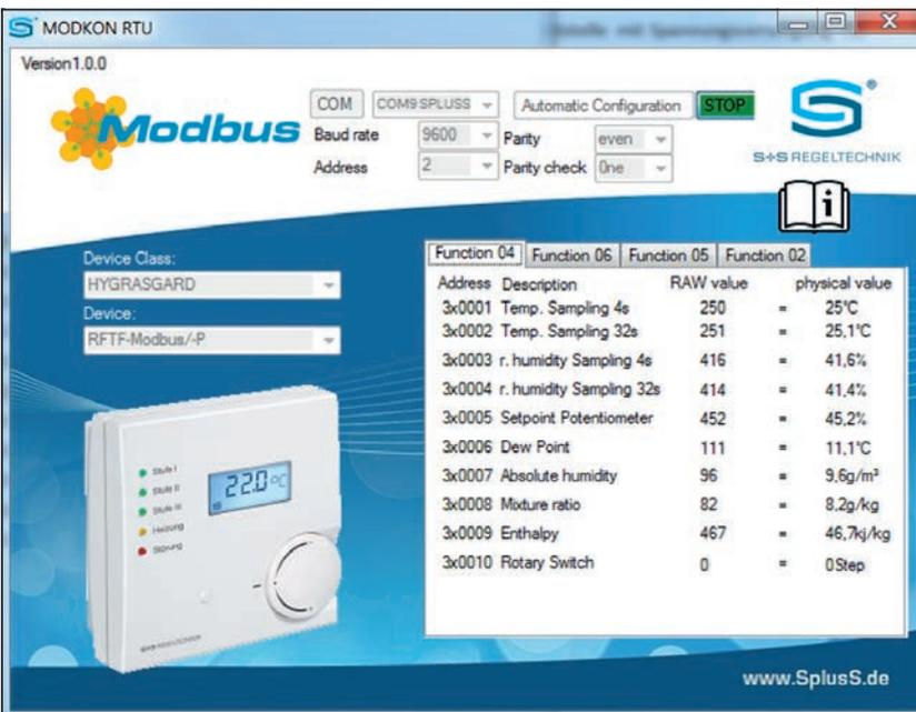
L'imm. mostra la maschera di immissione del software S+S MODKON RTU (compreso nella fornitura) sull'esempio della sonda Modbus S+S HYGRASGARD® RFTF-Modbus
