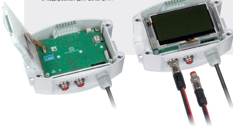
HFTM - EtherCAT P с дисплеем и линейным индикатором
