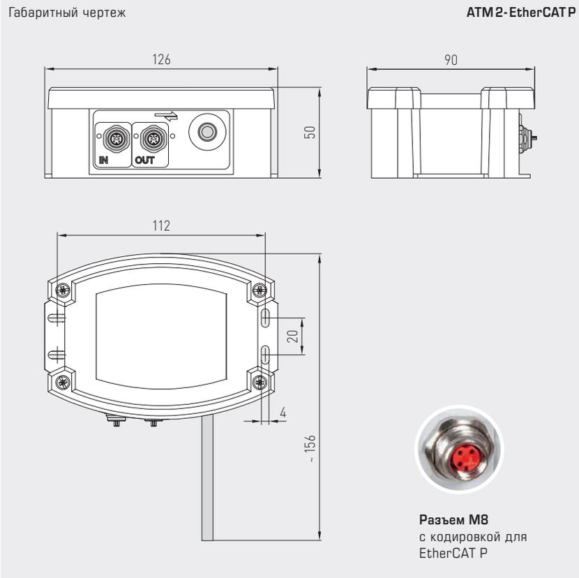
ATM2-EtherCAT P с дисплеем и линейным индикатором
